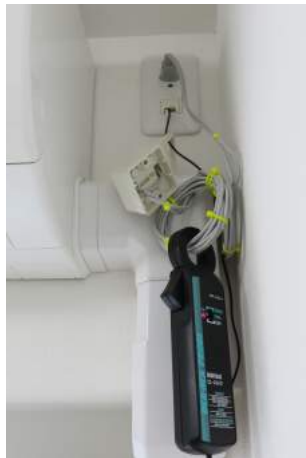
図4 カレントプローブの挿入状況
