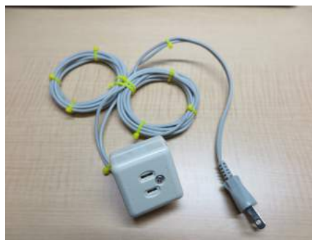
図3 ラインセパレーター (自作、10ターン)
